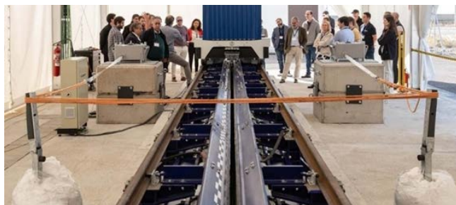
■ Silnik liniowy z przetłączaną reluktancją (SRLM) jako tor testowy z platformą
