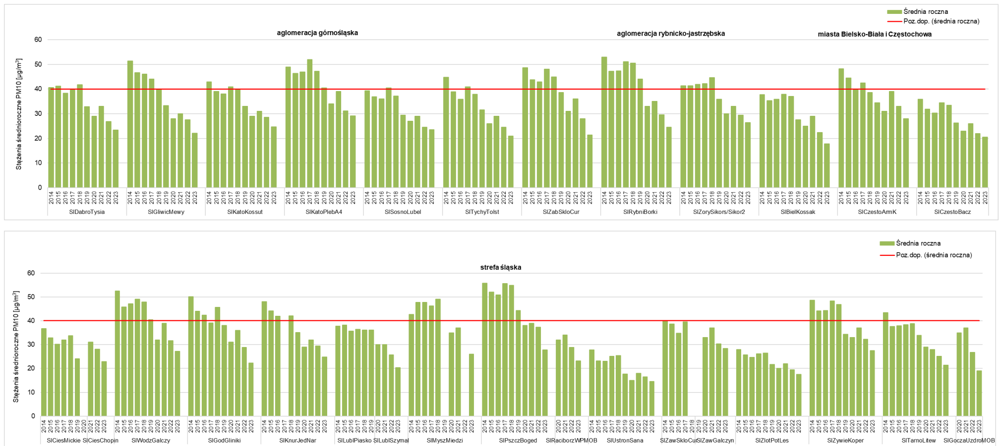
Rysunek 7.29. Przebieg wartości średniorocznej stężenia pyłu zawieszonego PM10 na poszczególnych stanowiskach pomiarowych w województwie śląskim, na tle poziomu dopuszczalnego w latach 2014 - 2023 [źródło: GIOŚ]
