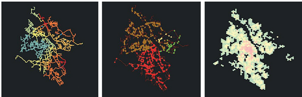
Ryc. 32. Kompozycje mapowe służące wizualizacji parametrów sieci ciepłowniczej: ciśnienia, temperatury i rozkładu mocy pomiędzy źródłami ciepła Źródło: ConnectPoint (2018)
