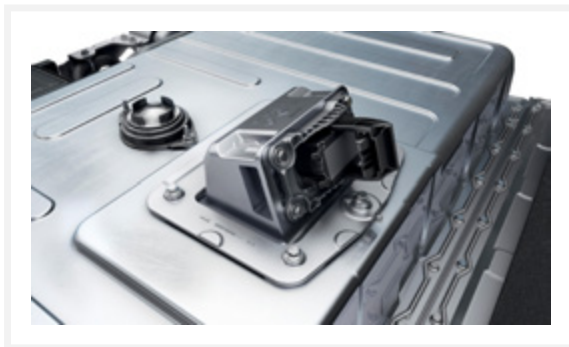
Rysunek 1. Akumulator trakcyjny Renault Megane E-Tech elektryczny z system Fireman Access oraz service plug
