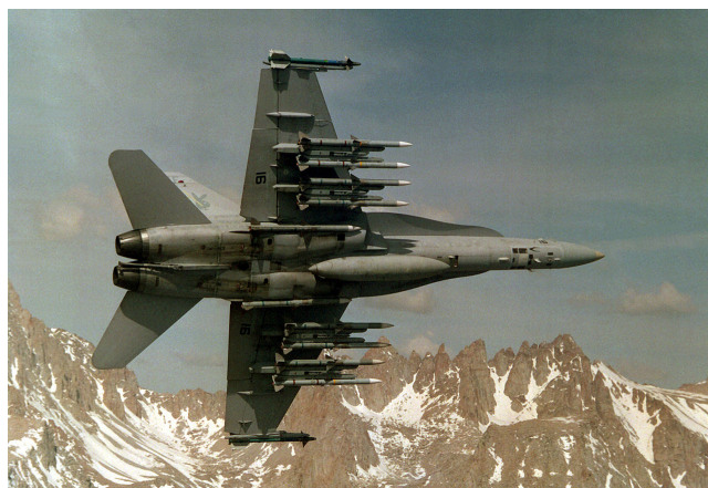
Myśliwiec F/A-18C Hornet należący do Air Test and Evaluation Squadron 4 (VX-4) w czasie lotu testowego, uzbrojony w dziesięć rakiet powietrze–powietrze średniego zasięgu AIM-120 AMRAAM i dwie rakietę AIM-9 Sidewinder. Autor: US Navy.
