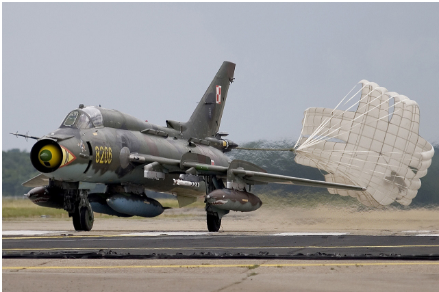
Samolot myśliwsko-bombowy Su22M4 lądujący z pomocą spadochronu hamującego. Autor: Chris Lofting GFDL 1.2.
