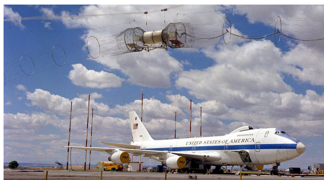
Test amerykańskiego samolotu dowodzenia Boeing E-4 AABNCP w symulatorze impulsu elektromagnetycznego (HAGII-C). Autor: Sgt. Ernie Stone.
