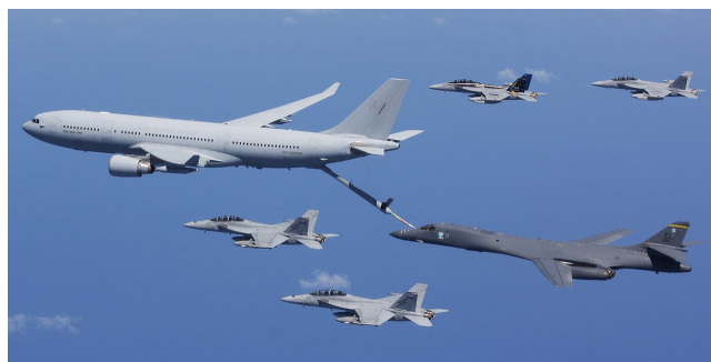
Australijski wariant Airbasa A330 MRTT (KC-30) podający paliwo amerykańskiemu bombowcowi Rockwell B-1 Lancer, w eskorcie czterech myśliwców Boeing F/A-18F Super Hornets i Boeing EA-18G Growler. Autor: Master Sgt. Farrah Kaufmann.
