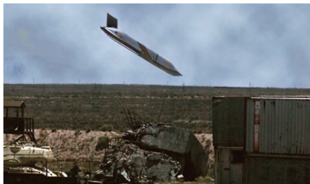
Pocisk manewrujący AGM-158A JASSM chwilę przed uderzeniem w cel na poligonie testowym. Autor: JASSM Program Office.
